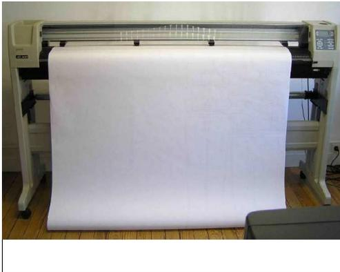
Mit einem solchen Plotter wird die Zeichenlage ausgedruckt.
