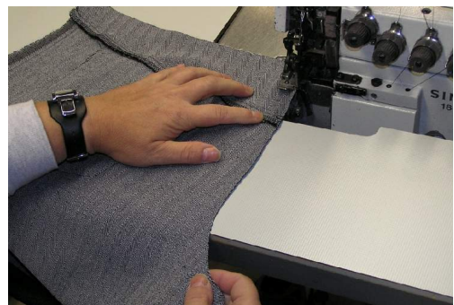
Hinterhosenteile an den Seiten und der hinteren Mitte versäubern
