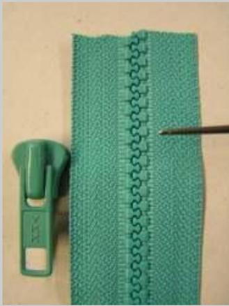
Schneiden Sie zuerst den Reißverschluss auf die gewünschte Länge plus 3-4 cm Mehrlänge zu.
